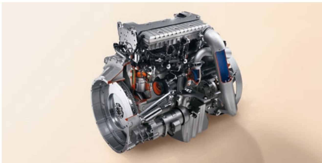
Четырехцилиндровый рядный двигатель с рабочим объемом 4,8 л имеет мощность 160 кВт (218 л. с.), обычно свойственную только шестицилиндровым двигателям. Тем не менее, он на 100 кг легче шестицилиндрового двигателя аналогичной мощности.
